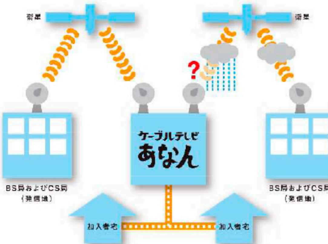
降雨減衰とは大雨や降雪、雨雲のために通信電波が減衰して(微弱になって)しまう現象のことです。当社で放送されているBSおよびCS放送のチャンネルは、放送衛星(BS)および通信衛星(CS)を経由して、テレビあなんの大型パラボラアンテナで受信し、皆様のご家庭へ放送されています。このため、電波発信地や受信地(阿南市)で集中豪雨や大雪の天候になると、BSおよびCS放送が受信できなくなったり、映像・音声の乱れが生じることがあります。(通常の降雨ではほとんど発生しません)
